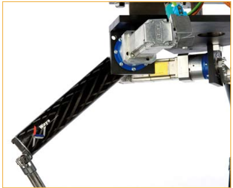
Detail van de bovenarm van vezelversterkte kunststof en de aandrijving.
