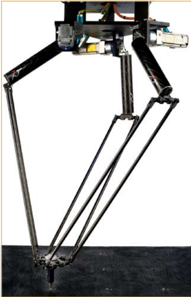
Een delta-robot verricht zijn pick & place functie met behulp van een bovenarm- en een uit parallellogrammen bestaande onderarmconstructie.
