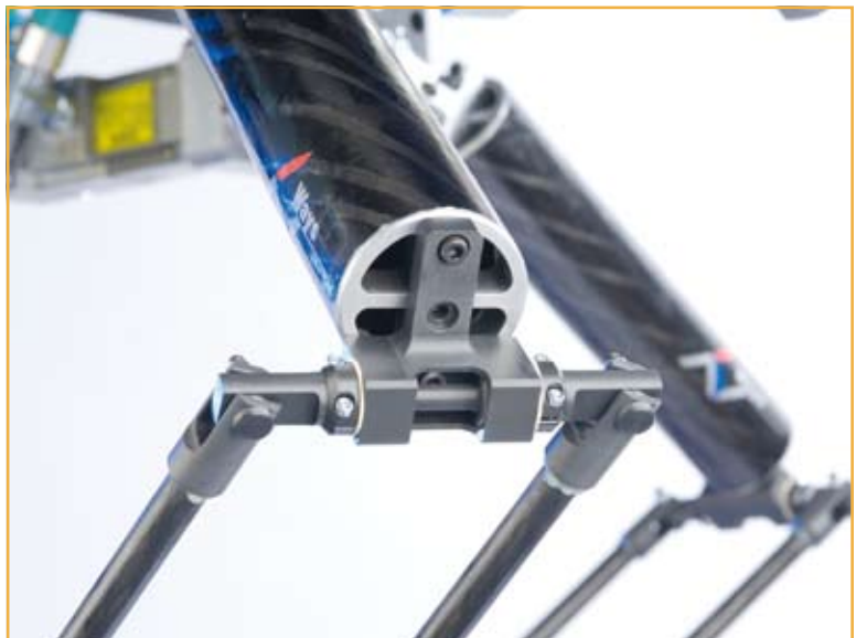
Detail van de bovenarm van vezelversterkte kunststof en de aandrijving.
