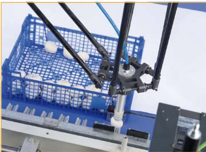
Via een band aangevoerde champignons worden met behulp van de SiWays-Spider robot in een bak overgebracht.
